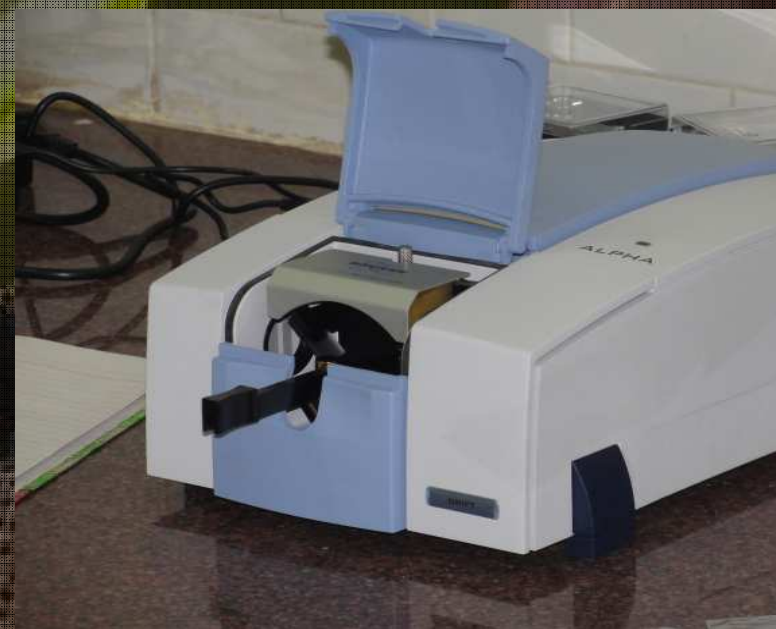
Alpha-FT MIR Spectrometer
